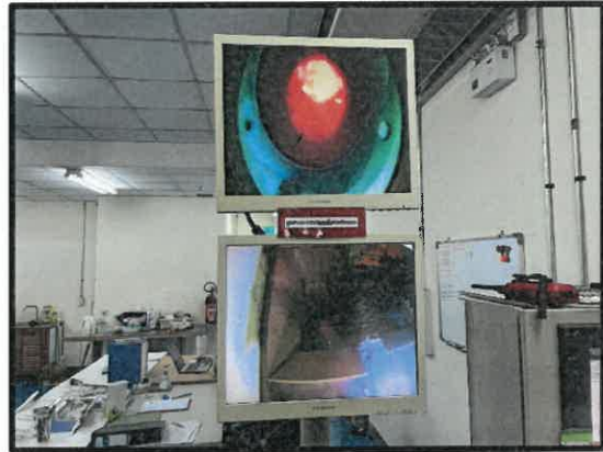
รูปที่ 3.1-2 ตู้ควบคุมอุณหภูมิในการเผา 800 - 1,200°C
